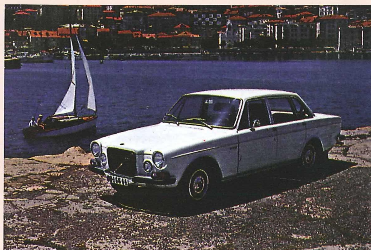
Το μοντέλο 164 ήταν παρεμφερές με το 144. Δεδομένου ότι το δεύτερο ψηφίο φανερώνει τον αριθμό των κυλίνδρων, αντιλαμβάνεται κανείς ότι το 164 ήταν μια έκδοση πιο εξελιγμένη, χάρη στον 6κύλινδρο κινητήρα της.
